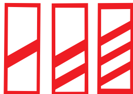
Vasúti átjárót előjelző táblák
